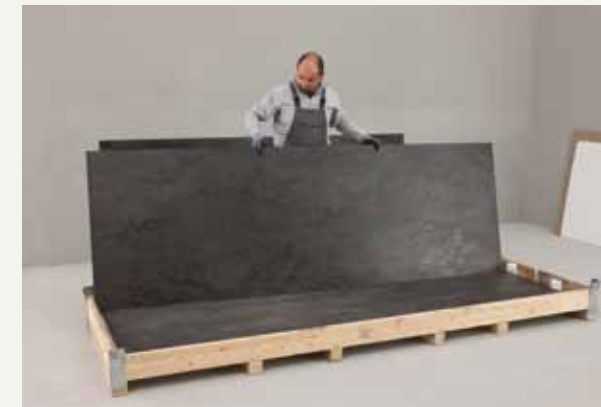
fig.4/5 / Positionner l'emballage à proximité de la surface du plan de travail ou de la zone de stockage. Soulever la plaque du côté long jusqu'à la situer verticalement. / Die Verpackung in der Nähe der Arbeits- oder Lagerfläche abstellen. Die Platte anheben und in eine vertikale Position bringen.
