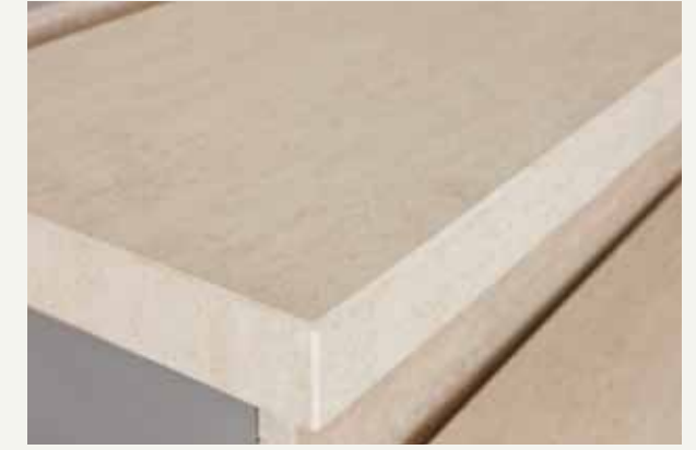
fig.29 /En général, les plaques Laminam 3 et Laminam 3+ ne requièrent le chanfreinage que de l'arête supérieure ; dans le cas de Laminam 7 et Laminam 3+3, un double chanfreinage peut être prévu : dans ce cas, nous pouvons utiliser des outils permettant de réaliser l'opération en un seul passage de fraise. Pour le chanfreinage des coupes curvilignes, il faut nécessairement utiliser une machine à contrôle numérique équipée d'une meule à 5 axes. Pour effectuer un meulage manuel, fixer un disque abrasif à une polisseuse et chanfreiner. Dans ce cas, la précision du résultat dépendra de l'habileté de l'opérateur chargé du travail. / Allgemein ist es bei Laminam 3- und bei Laminam 3+-Platten nur erforderlich, die obere Kante abzuschrägen, bei Laminam 7 und Laminam 3+3 kann eine zweifache Abschrägung vorgesehen sein: In diesem Fall kann man Werkzeug verwenden, das die Aktion mit einem einzigen Arbeitsgang der Fräse ausführt. Für die Abschrägung von kurvenförmigen Schnitten muss unbedingt eine CNC-Maschine mit einer fünfachsigen Schleifscheibe verwendet werden. Um mit der Hand zu schleifen, eine Schleifscheibe auf einer Schleifmaschine anbringen und die Abschrägung ausführen. In diesem Fall wird die Genauigkeit des Ergebnisses von den Fähigkeiten des Technikers abhängen, der die Arbeit ausführt.
