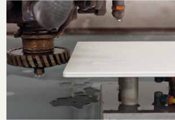
fig.27 /Pour former et polir le chant, effectuer un premier passage avec une meule diamantée pour conférer la mesure et la forme souhaitée au bord, puis effectuer un deuxième passage avec une meule de polissage. /Für die Formung und die Politur der Kanten einmal mit der Diamantschleifscheibe abziehen, um der Kante das entsprechende Maß und die gewünschte Form zu verleihen; ein zweiter Arbeitsgang wird
