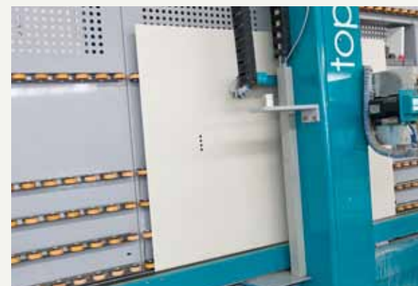
fig.23 / Les opérations de perçage peuvent être exécutées sur n'importe quel format de plaques Laminam grâce aux machines conçues spécialement pour percer le verre ou les pierres naturelles. / Bohrungen können dank der geeigneten Maschinen, die für die Bohrung von Glas oder Naturstein gedacht sind, auf allen Formaten der Laminam-Platten ausgeführt werden.
