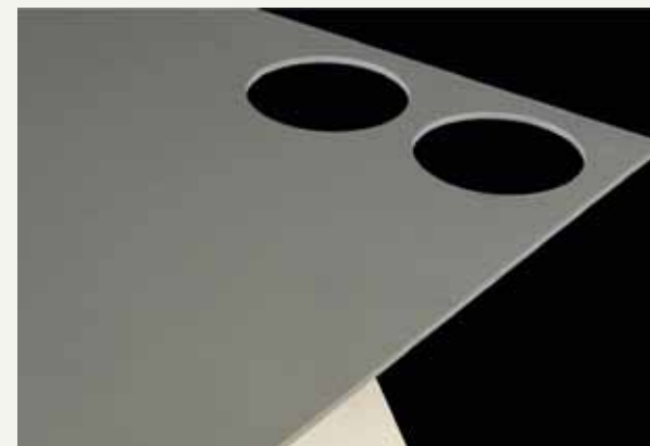
fig.22 / Il faut tout d'abord exécuter un orifice à l'aide d'un foret, puis utiliser éventuellement une fraise en chandelle pour obtenir la dimension souhaitée. Diamètre minimum : 4-5 mm. Vitesse de travail 40 mm/min; rotation du mandrin 900 tours/min. / Zuerst muss mit der Stichsäge ein Loch gebohrt werden, danach eine Schaftfräse verwenden, damit das Bohrloch die gewünschten Maße erhält. Mindestdurchmesser: 4–5 mm. Arbeitsgeschwindigkeit 40 mm/min; Umdrehung der Spindel 900 UpM (Umdrehungen pro
