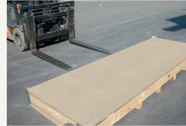
fig.2 /Pour soulever et déplacer les barquettes de plaques de dimensions 1 000 x 3 000 mm, en utilisant des chariots élévateurs ou des grues de chantier, il est important d'enfourcher l'emballage du côté long en veillant à se situer en son centre et en allongeant au maximum les fourches qui devront faire prise sur toute la profondeur de la palette. /Für das Anheben und Transportieren der 1000x3000 mm Plattenpaletten unter Verwendung von Gabelstaplern oder Baustellenkränen ist es wichtig, die Verpackung von der Längsseite aufzugabeln, sich selbst zentral zu positionieren und darauf zu achten, die Gabeln maximal zu verbreitern, damit die Palette in ihrer gesamten Tiefe ergriffen werden kann.
