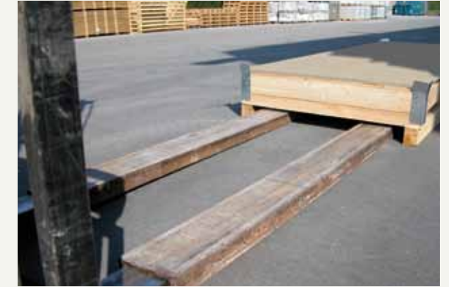
fig.3 / S'il fallait enfourcher la palette du côté court, par exemple pour décharger un container, pour une manutention correcte du produit, il faut utiliser des fourches de 2,5 m de long au moins. / Wenn es, wie zum Beispiel beim Entladen eines Containers, erforderlich ist, die Paletten an ihrer Breitseite zu fassen, müssen für den Transport der Ware Gabeln mit mindestens 2,5 m Länge verwendet werden.
