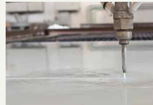
fig.24 / L'hydrojet permet de percer des orifices d'un diamètre pouvant même être inférieur à celui obtenu avec les machines à contrôle numérique. Vitesse de travail 1500 mm/min. / Die Wasserstrahlmaschinen erlauben die Ausführung kleinerer Durchmesser, als dies mit CNC-Maschinen möglich ist. Arbeitsgeschwindigkeit 1500 mm/min.
